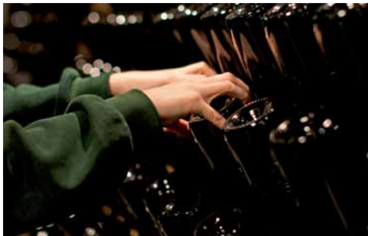
Bei der klassischen Flaschengärung wird jede Flasche vier Wochen lang von Hand »gerüttelt«.
