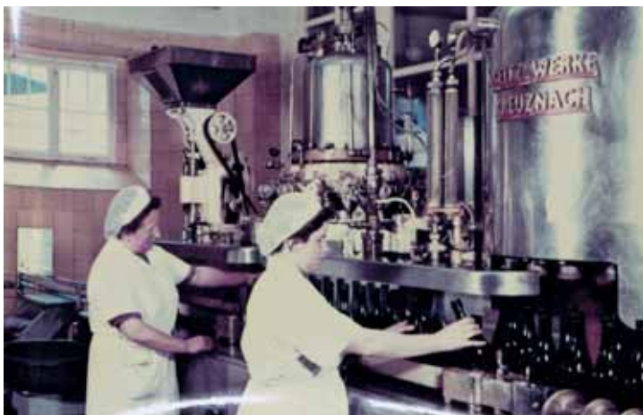
Abfüllen von Sekt auf importierten Seitz-Maschinen, 1958
