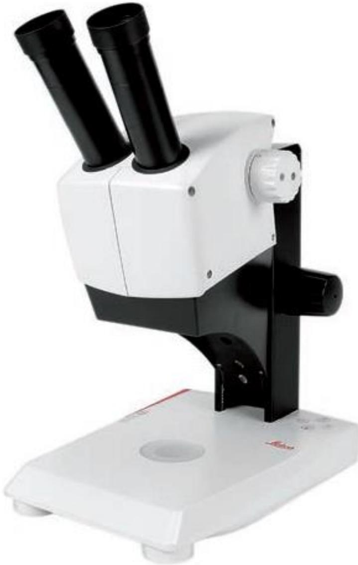
1. Ein **Binokular (Stereomikroskop)** ist ein spezielles Lichtmikroskop, bei dem für beide Augen ein getrennter Strahlengang bereitgestellt wird. **Das Objekt wird mit beiden Augen betrachtet!**
